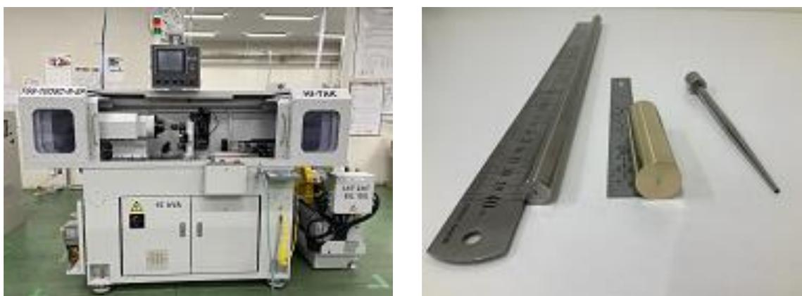
図 723 微細加工機(Φ0.5 mm対応ガンドリルマシン)(左), Φ0.5×60L 加工サンプル(右写真中央)
