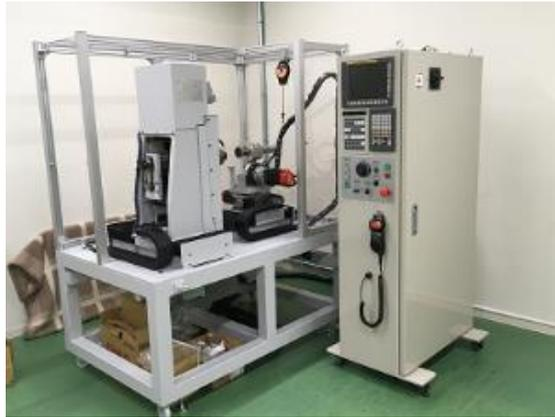
図 24 小径専用自動再研磨装置
