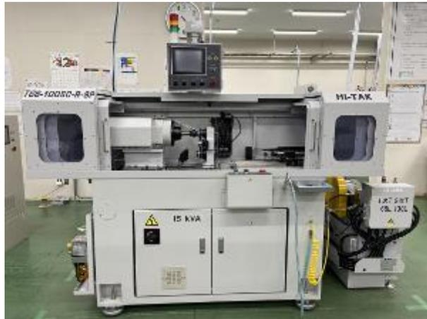
図 70 φ0.5～1.0mm 微細深孔加工用ガンドリルマシン
