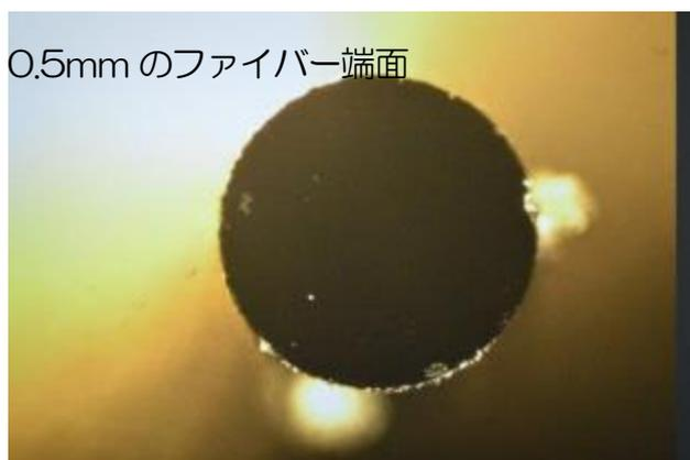
図 65 画像装置と対物レンズを用いたファイバー端面の画像
