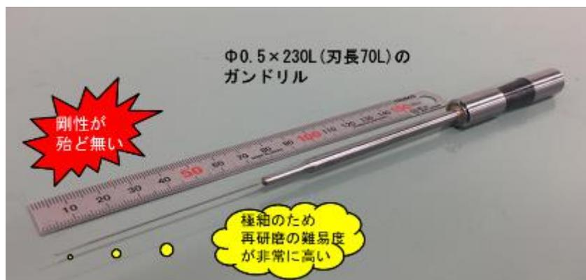
図 16 φ0.5mm 世界最小径ガンドリル
