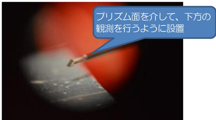
図 66 ファイバー型プローブによる金属表面の観測実験
