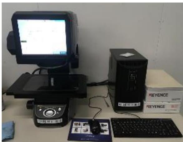
図 28 医療用工具専用測定機(3D形状測定機)
