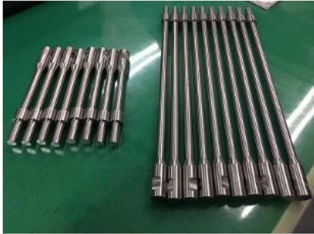
図 35 脳外科用手術工具(ブランク材)～川下企業要求により製作
