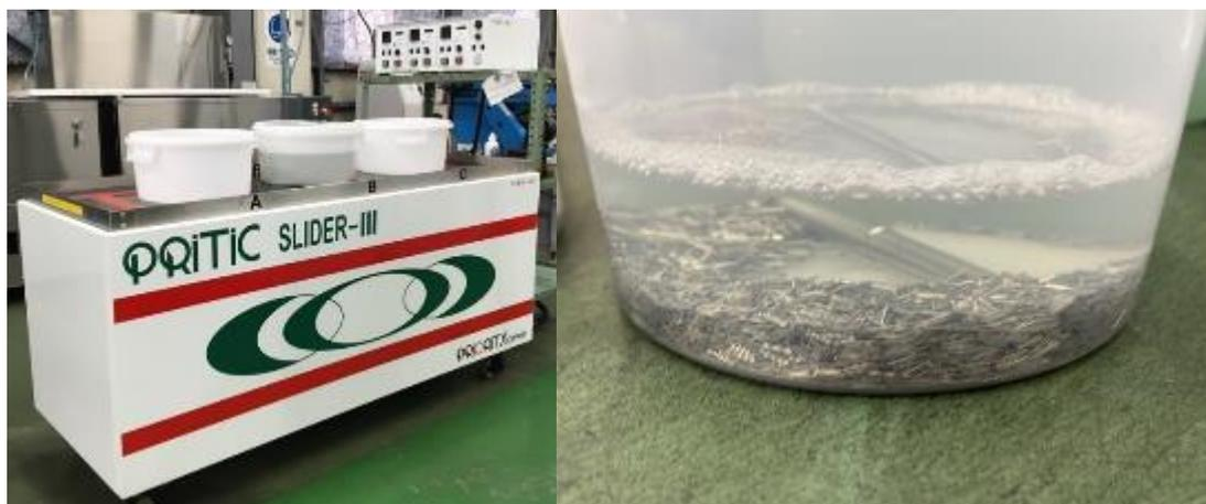
図 27 磁気研磨装置(左), 洗浄ワーク拡大写真(右)
