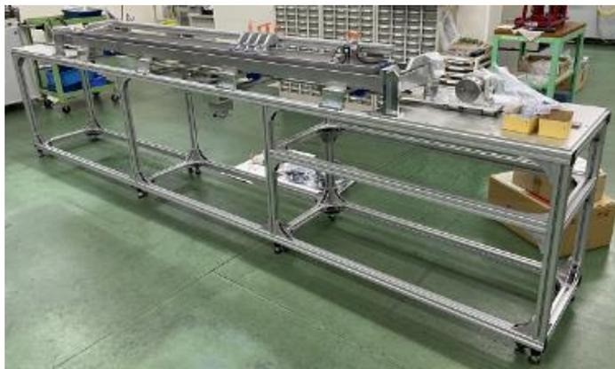
図 26 ワイヤー細穴研磨装置
