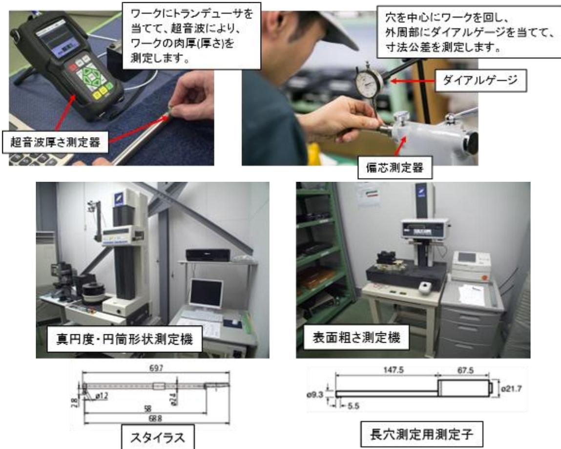
図4 左上：厚さ測定、右上：同芯度測定、左下：真円度測定機、右下：表面粗さ測定機
