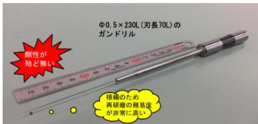
図 71 φ0.5mm 世界最小径ガンドリル
