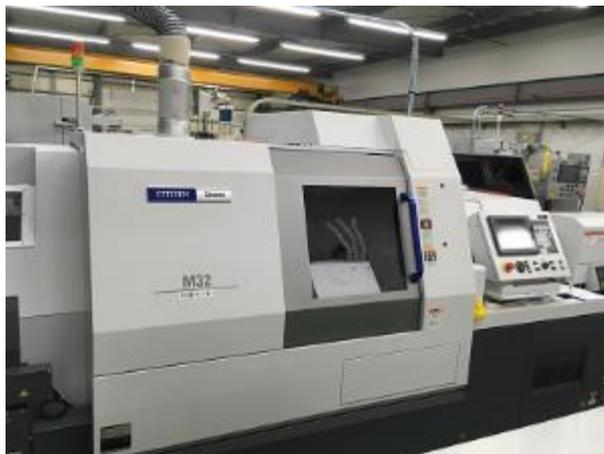
図 23 CNC 旋盤 シンコム M32Ⅷ(10 軸制御)
