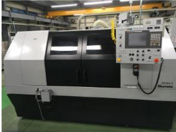
図 22 CNC 円筒研削盤 OGM250UNCⅢ
