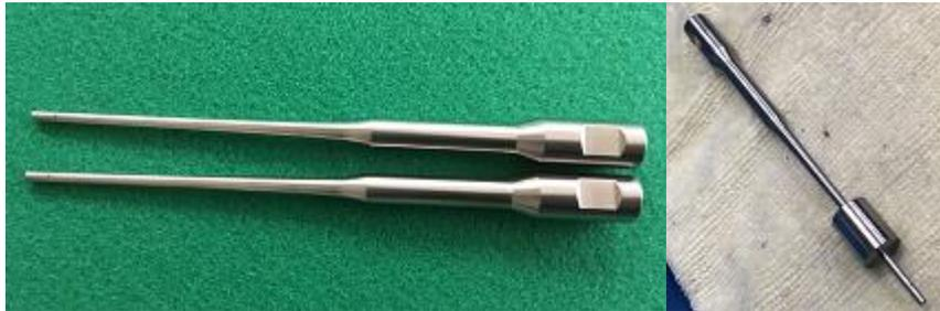
図 40 脳外科用手術工具加工サンプル(左)、治具対応(右)
