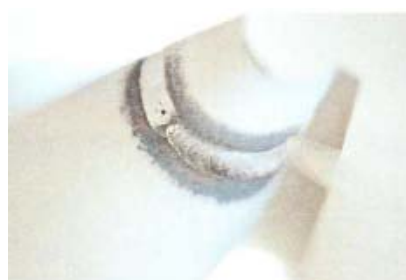
図 1-1-6 TIG 自動溶接機による溶接 裏波溶接が均等にできる
