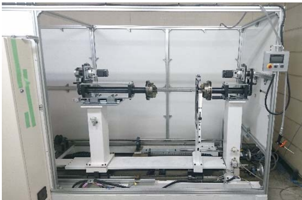
図 2-2-1. Rev3.0 チャック横移動モータ追加 および 回転左右独立化
