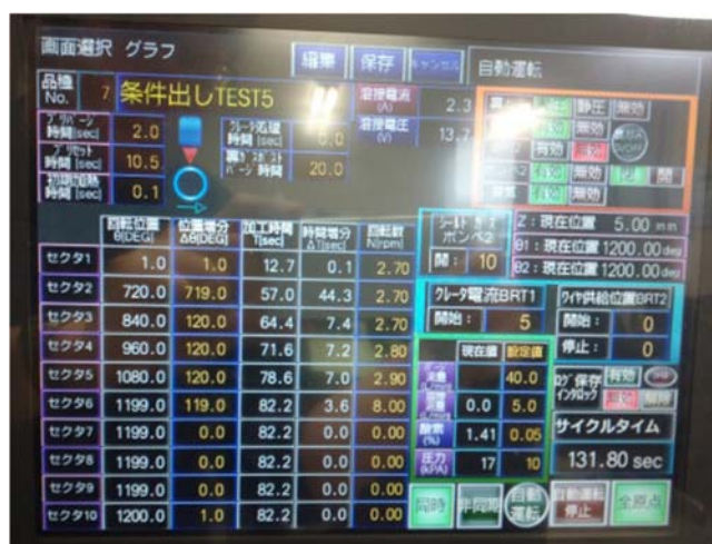
図 2-2-3. Rev3.2 溶接後強制空冷機能追加 および 溶接電流ログ取り機能強化
