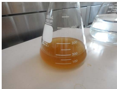
100k フィルターによる限外ろ過後の 高分子量成分溶液
