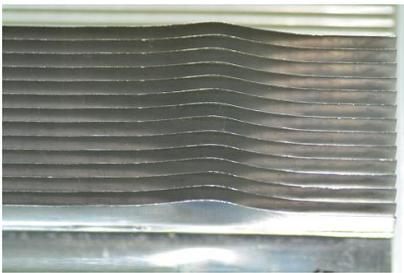
図19 フィン加工方向への変形
