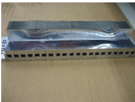
図21 フィン加工方向への変形が発生する加工条件での加工
