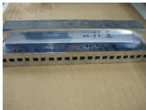
図22 フィン高さ方向への変形が発生する加工条件での加工
