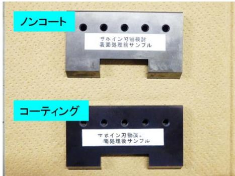
図12 実験評価用刃物
