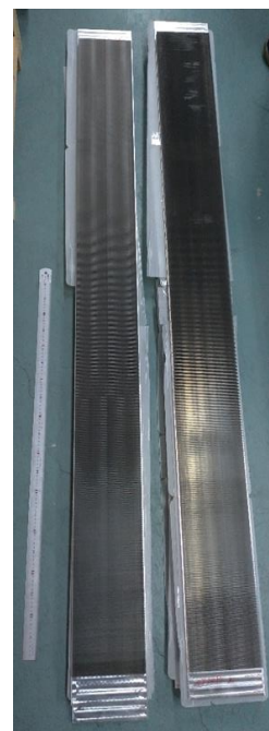
長さ2,000mmの熱交換器ユニットへの組立状態 ヒートシンク加工上り
