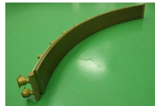
長さ2,000mmの熱交換器ユニットへの組立状態 ヒートシンク加工上り
