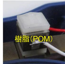
図2-1 探針支点とカセンサ部支持部の安定性向上
