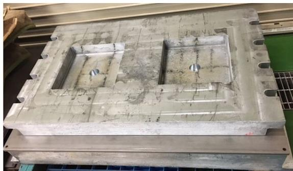
図2 上蓋成型用金型：上下型
