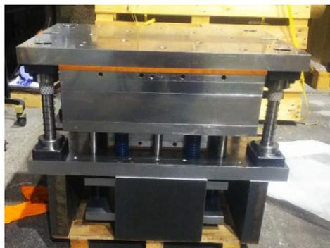
図6 CFRP 試験片成形用金型
