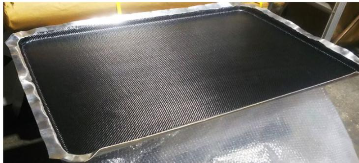
図5 アルミ+CFRP の上蓋成形品
