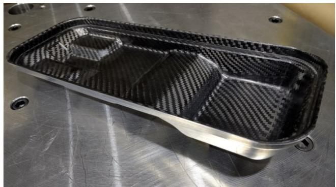
図14アルミ外箱とCFRP内箱のプレス一体成形
