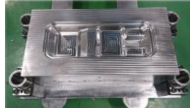
図9CFRP 金型：ダイ
