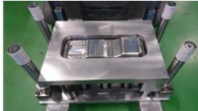
図8CFRP 成形金型：パンチ
