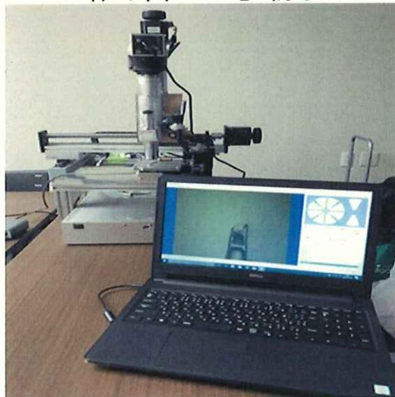
図2 自動ピッキング装置単体としての駆動部
