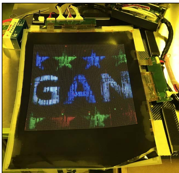
図 31. フレキシブルディスプレイモジュールの試作
