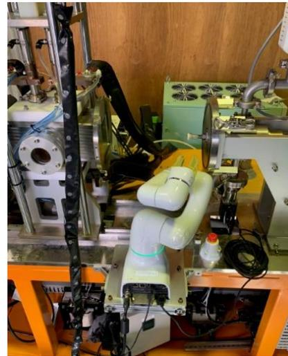
図 35 通電拡散接合装置に取り付けた材料移載装置の外観
