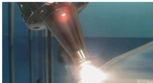
図-12： レーザー溶接イメージ図
