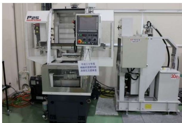
図 2-1 くし刃型旋盤と 30MPa 超高圧噴射装置試作 1 号機
