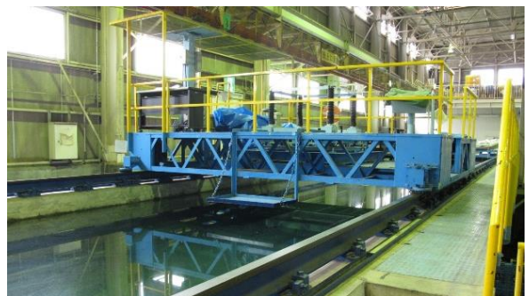
図23 多目的実験水槽全体写真
