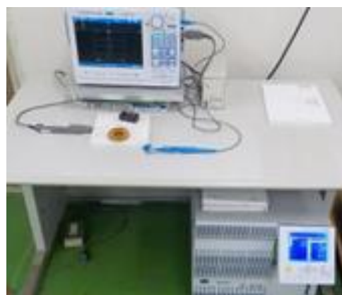
図1 3 高周波磁気特性評価設備
