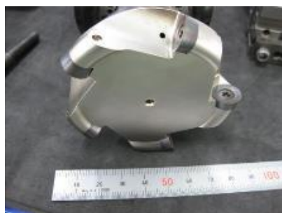
フライスカッター （ \phi 12 チップ、5 枚刃）
