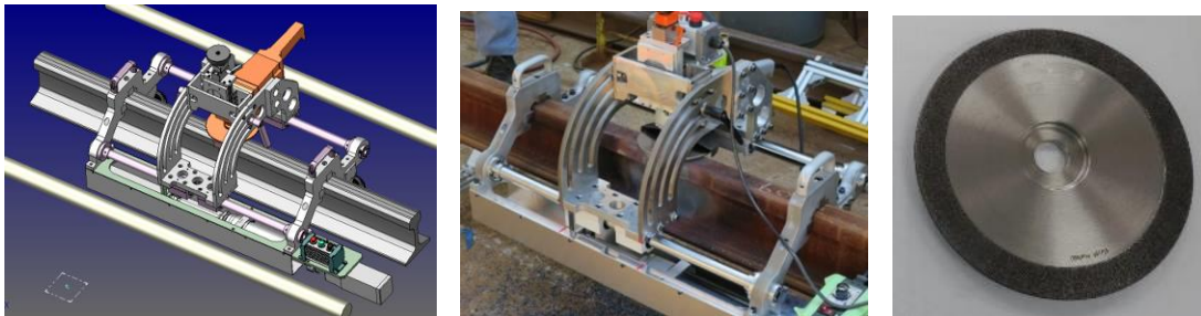
図 2-5 仕上げ加工機 Ver.2 の 3D-CAD 図面と試作機と工具
