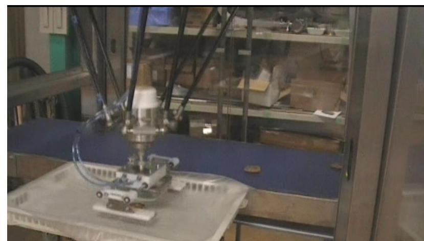
図2-5-6:開発したチャック式ハンドによる食肉ハンバーグの移載動作
