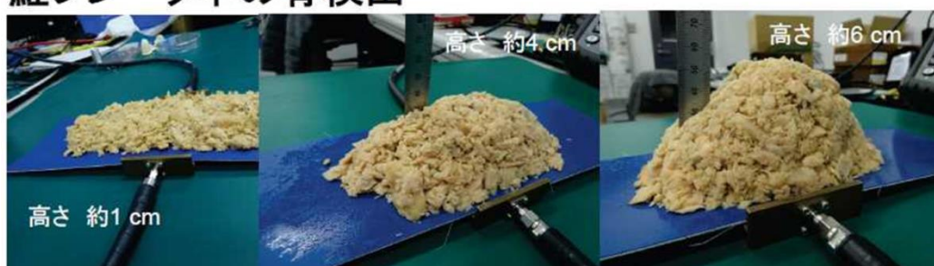
図2-2-1: 伝送線路型センサによる鮭フレーク中の異物検出試験の様子
