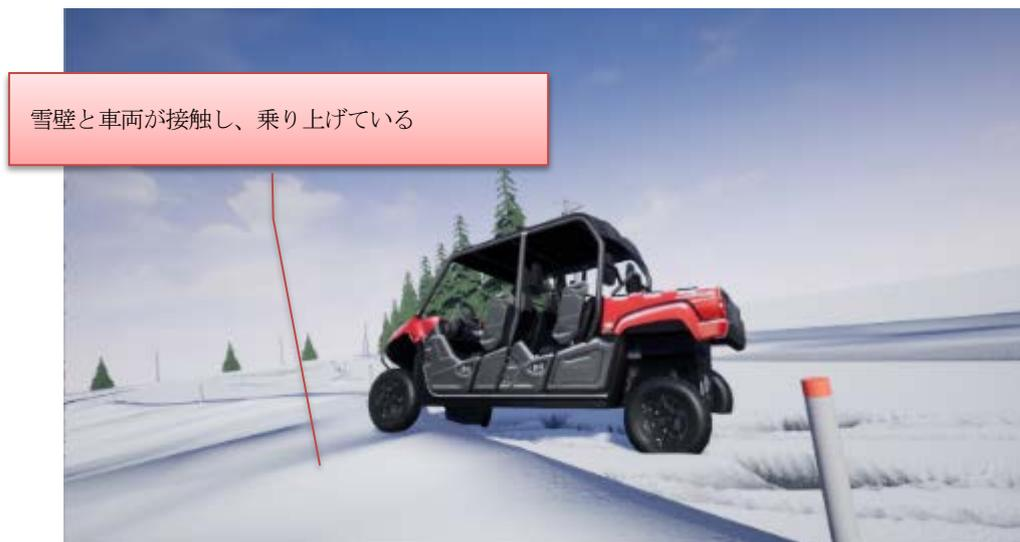
図 2-2-8-1(7) 雪壁 40cm、雪壁衝突時
