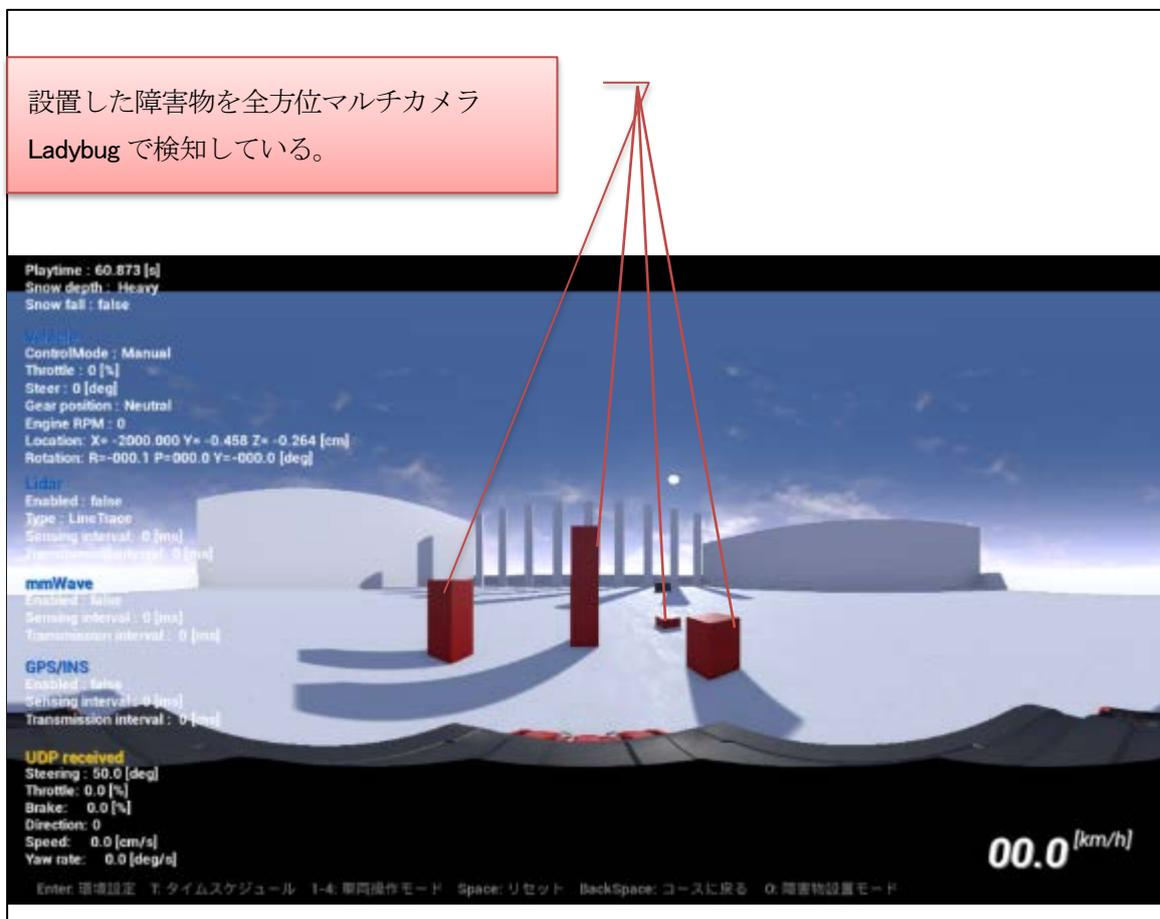
図 2-2-5-2(4) 障害物の検知結果(全方位マルチカメラ Ladybug)
