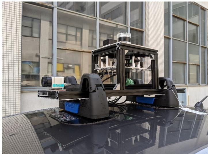
センサを搭載した実験車両(左)および搭載したセンサ
