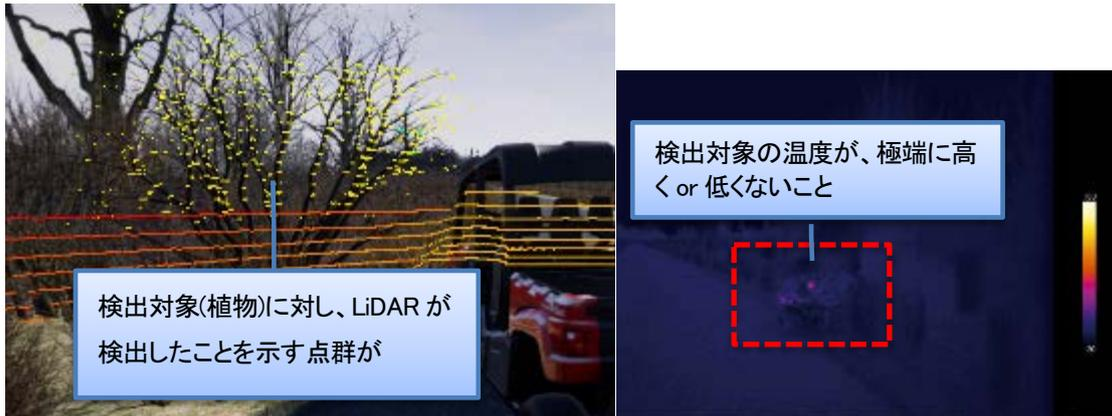
図 3-2-1(17) 苫東コースでのセンシング例①(左：LiDAR 右：サーモグラフィ)
