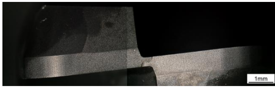
(a) UV 研磨前の PFR-NewPCD の逃げ面
