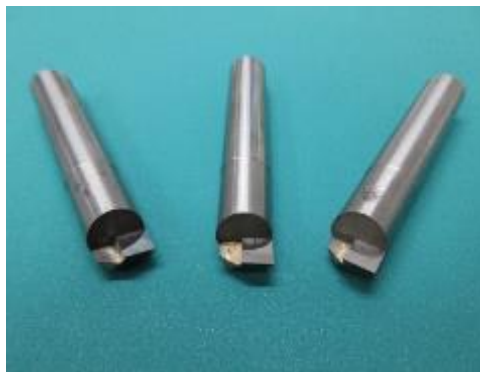
図 11 試作した加工評価用 1 枚刃 PCD エンドミル
