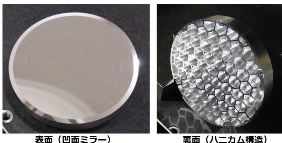
図6 難燃性マグネシウム合金で製造した大型球面ミラー
