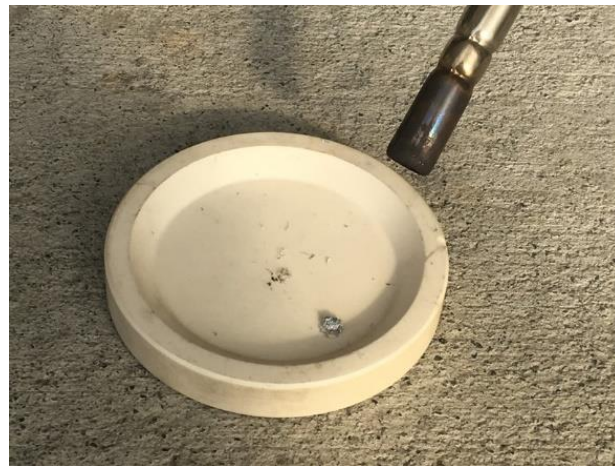
図4 切りくずの燃焼実験の様子
