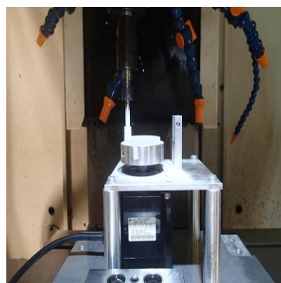
図 28 定圧装置を用いた機上ツルレーイング
