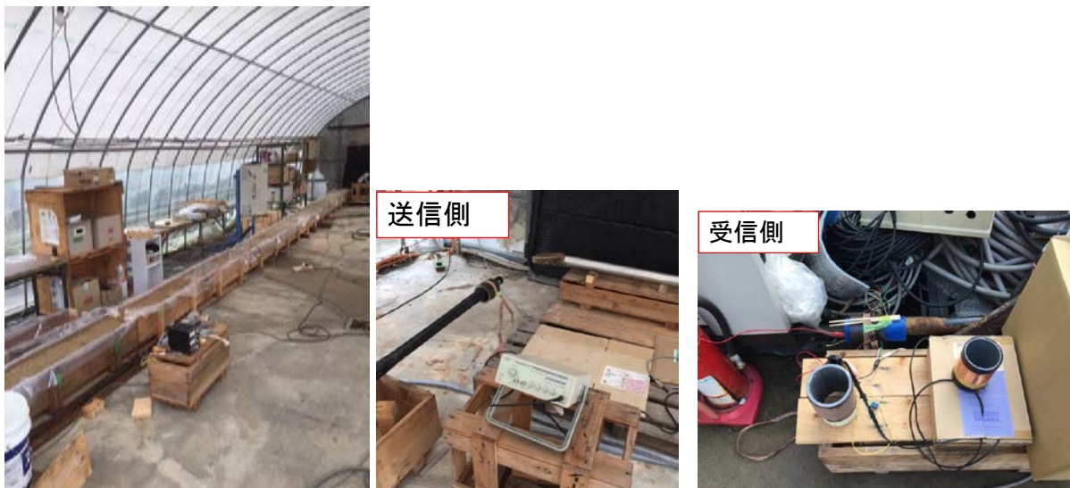
図 7 鉄製ロッドを用いたデータ送受信試験
