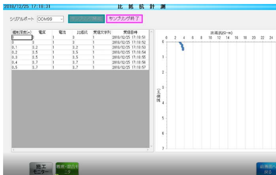
図9 施工管理装置での比抵抗値測定結果表示例
