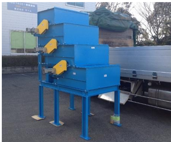
図9 夾雑物除去装置（木屑用）
