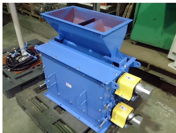
図8 夾雑物除去装置 (ゴム用)
