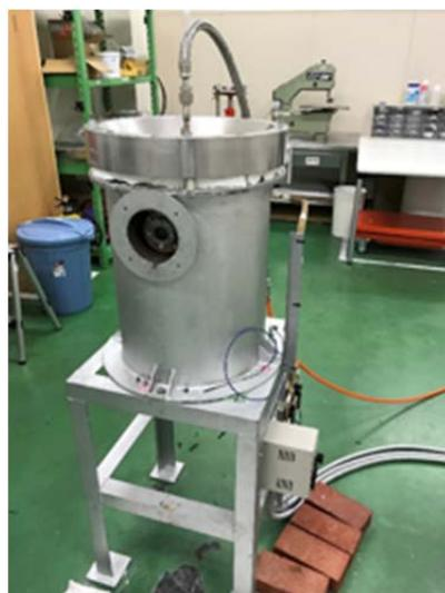
写真 1-2 横型吹出し試験機
