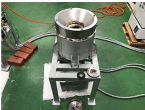
写真 1-1 縦型吹出し試験機
