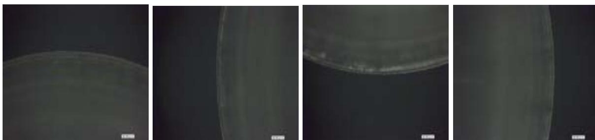
写真3-7 製作した使用前の丸刃
