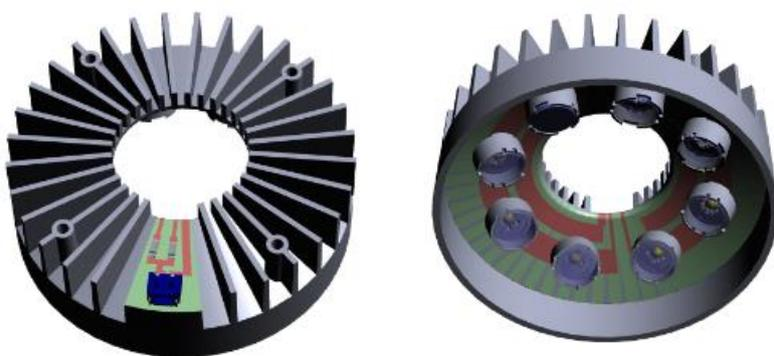
図7-4 開発品 B の筐体設計（完成図）
