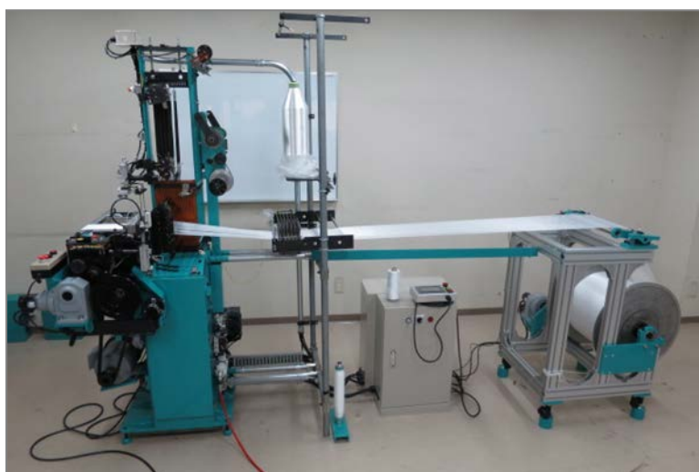
図7 繊維型太陽電池緯糸挿入織機
