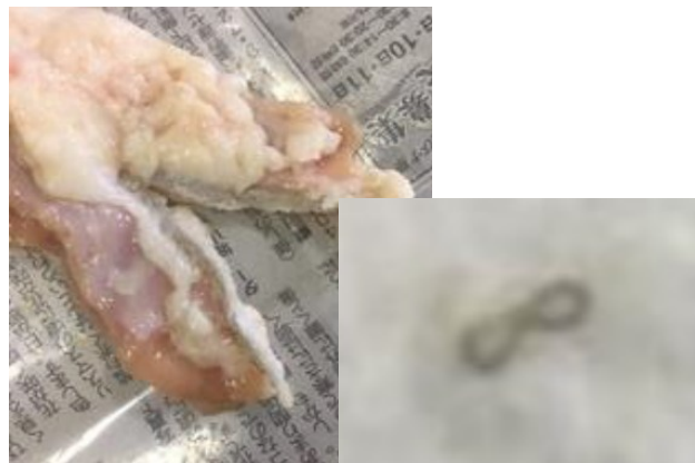
図 1-4(D) 生体組織片に対して試打した状況とステープルの変形状態
