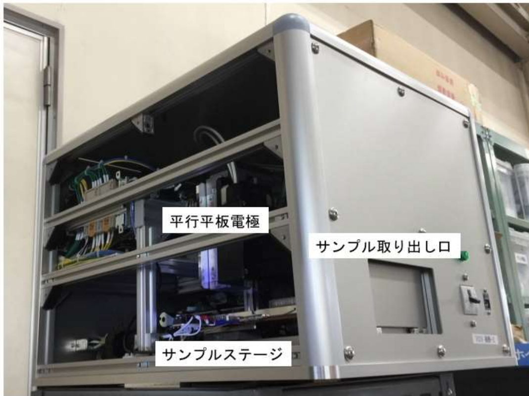
図 2-12b 一体型マルチサンプル用活性酸素生成装置
