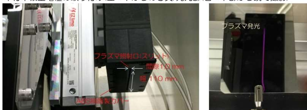
平行平板型電極と96穴プレートの位置関係
