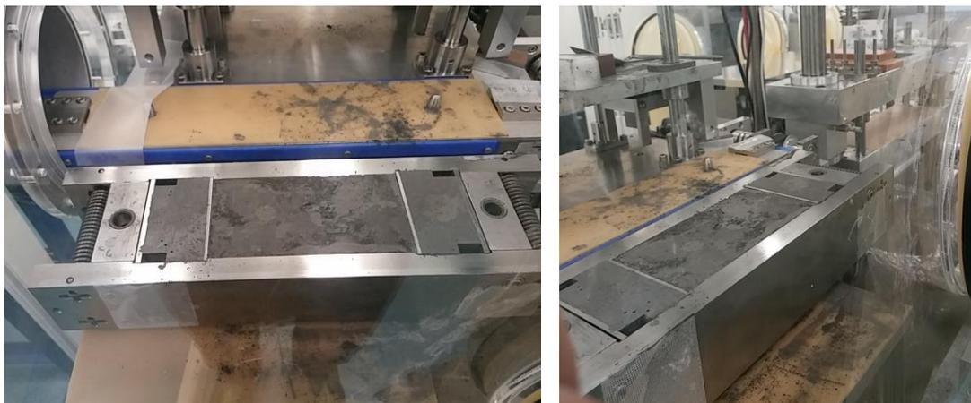
図 29. 大型モールドに粉末充填後の状態
