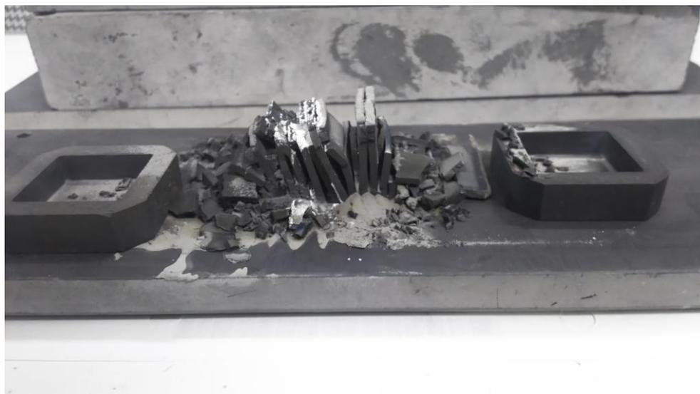
図 76. 9×9×厚さ 1 mm モールドにて、隙間に Al<sub>2</sub>O<sub>3</sub> を投入した焼結体
