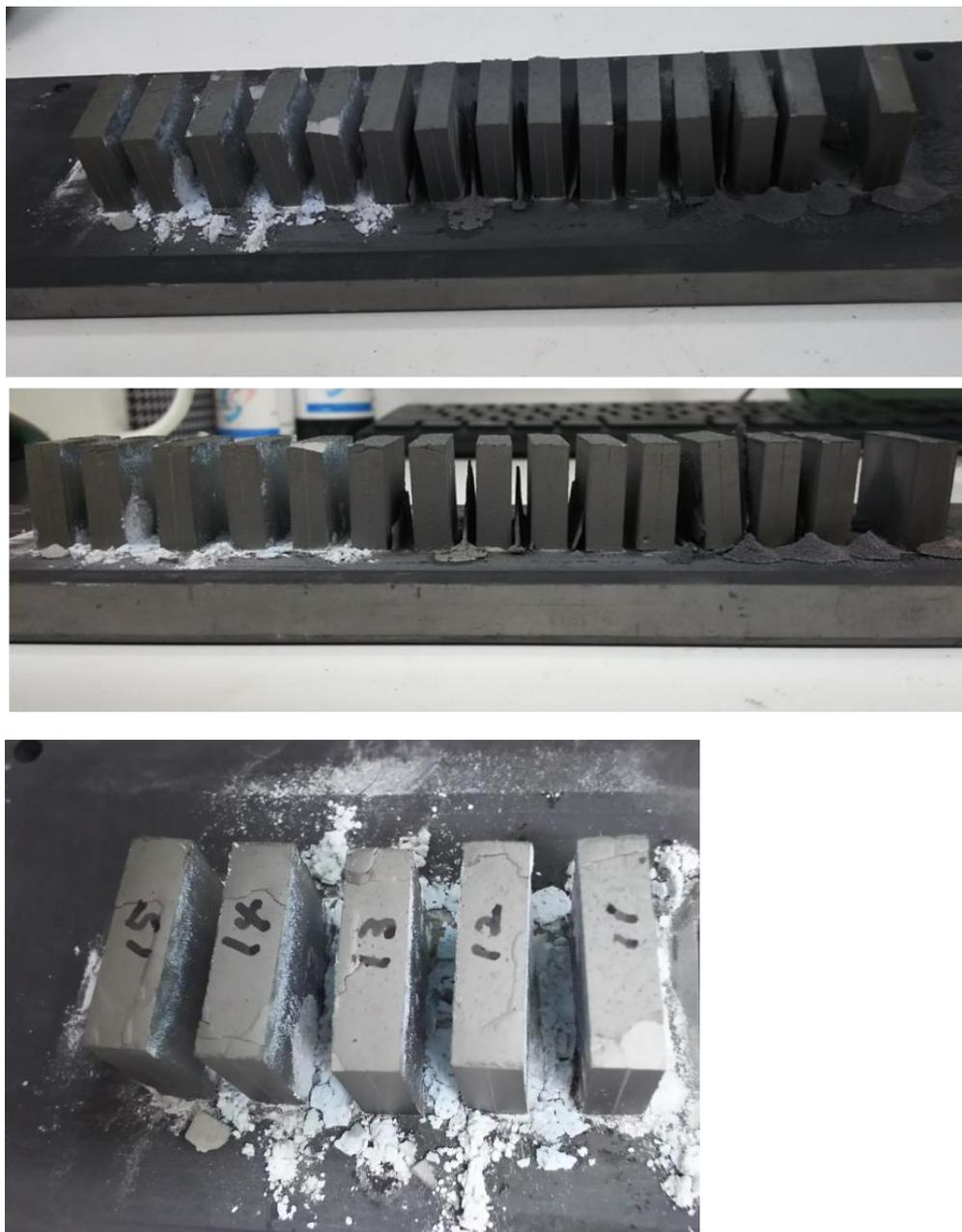
図 73. 倒れ防止対策を施した切込み法による焼結後のサンプル
