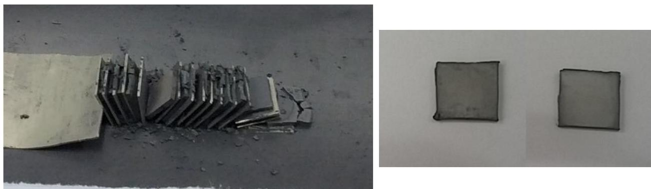
図 80.  $t=1$  mm モールドで作製 ( $9 \times 9 \times 1$  mm) した薄板焼結体
