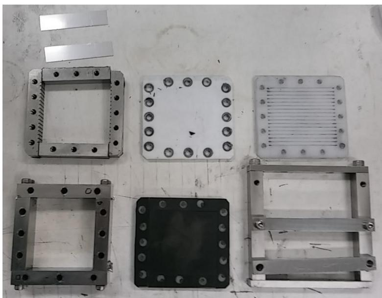
図 83. 作製した 2.4 mm幅-16 連積層モールド
