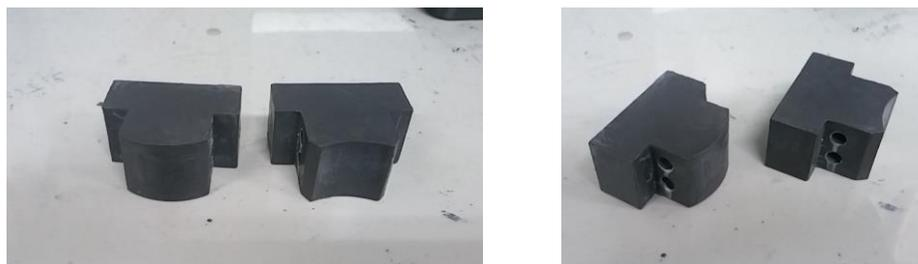
図 40. 瓦型磁石のモールドの磁極
