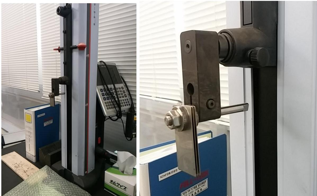
図 61. ハイトゲージを利用した仕切り板切込み装置
