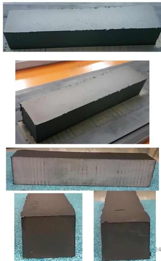
図 12. 磁極を用いた焼結体の外観
