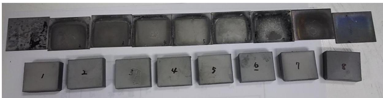
図 90. 5 回繰り返し使用した仕切り板 (SUS304+Si オイル)
