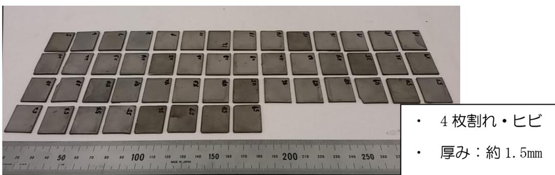
図 52. 焼結後の極薄板磁石
