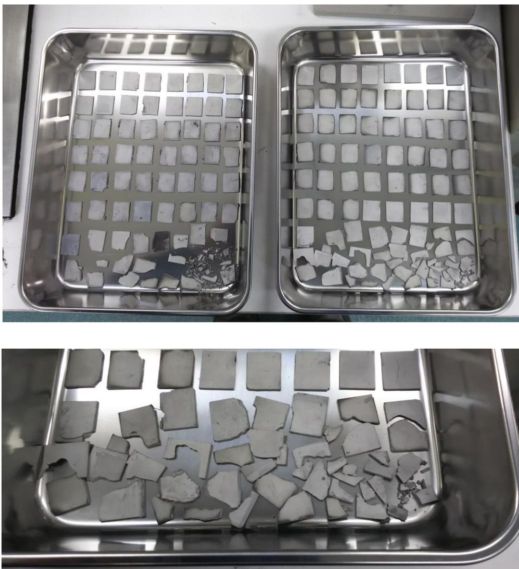
図 55. 秤量充填法で作製した焼結後の極薄板磁石
