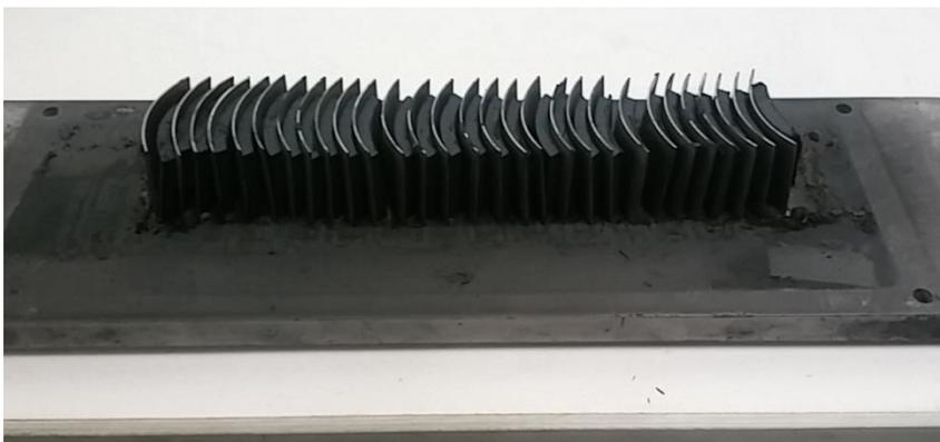
図 47. 秤量充填した瓦型磁石の焼結後の様子
