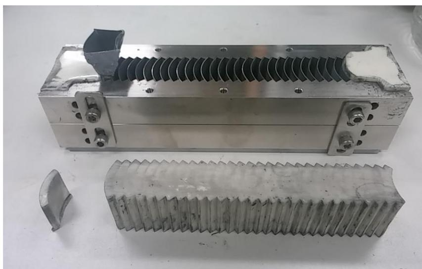
図 46. 瓦型磁石の秤量充填用の装置
