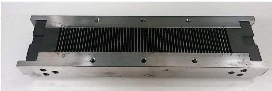
図 51. 極薄板磁石モールド
