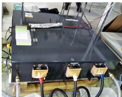
図 4：高速電流インバータの外観（出力 300kVA）
