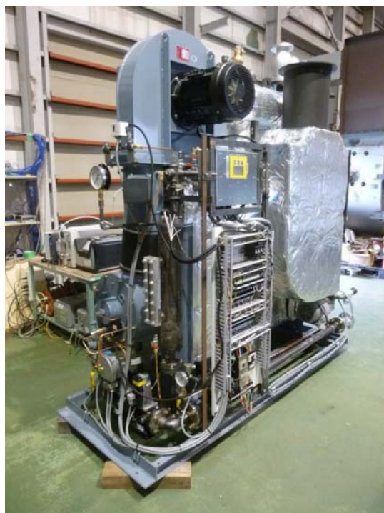
図8. 1200kW（蒸発量 2t/h）用ボイラ本体
