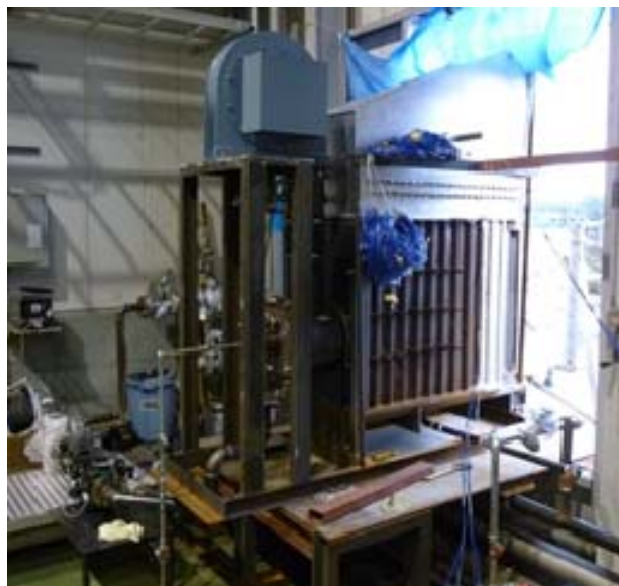
図7. 300kW 試験ボイラ本体
