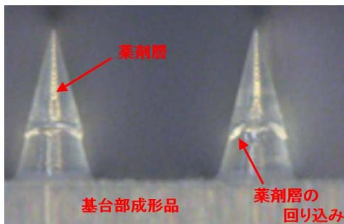
図18. 基台部と薬剤層の接着具合
