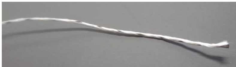
図5 ダブルカバリング法によるコミングルヤーン外観
