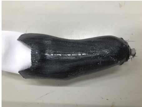
図22 亀裂の生じたCF RTPソケット
