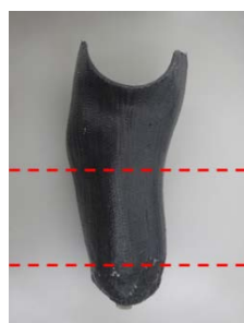
図29 修正後のCFRTPソケットの周径測定位置
