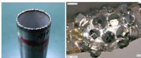
図 3-2-3 工具の端面とダイヤモンド砥粒
