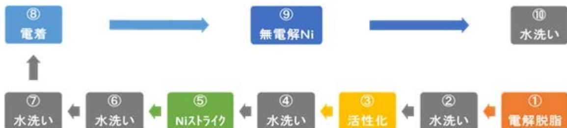
図 3-1-2 穿孔工具の電着工程
