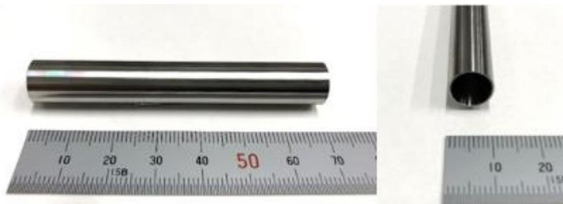
図 3-3-1 チタン合金 (Ti-6Al-4V) 製骨穿孔中空工具合金
