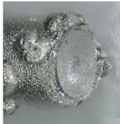
図 2-1-6 捻回試験による破断面
