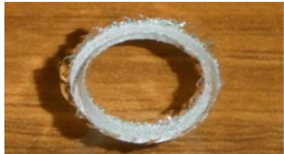
図 3-2-5 速度 3mm/s での穿孔結果
