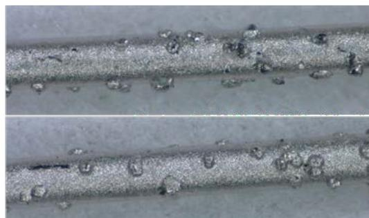
図 2-1-3 ステンレスを用いたワイヤの表面
