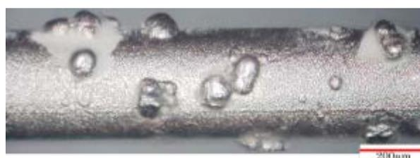
図 2-1-10 アクリル加工後のワイヤ工具表面
