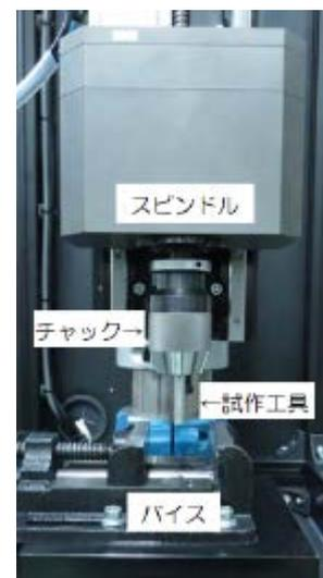
図 3-1-5 骨穴加工装置
