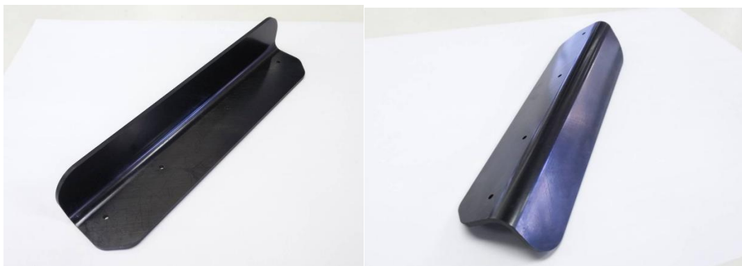
図 16 切削加工によりトリム、穴あけ加工後
