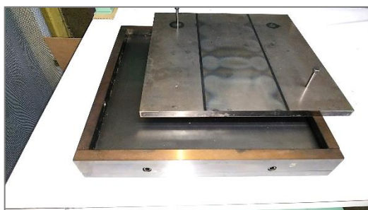
図 11 □370mm 平板用金型及び採取試験片
