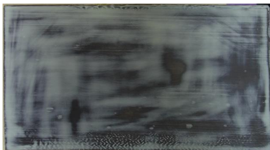
図 30 平滑な Primer-Surfacer 塗装表面と Primer-Surfacer サンディング後の表面
