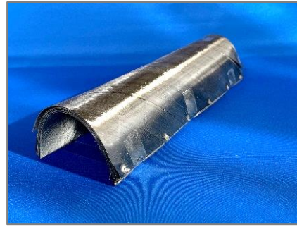
図 19 加圧成形状態及び治具から取り出した積層品
