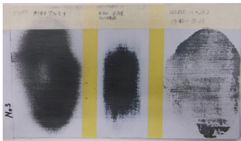
図 27 塗装膜の剥離試験結果
