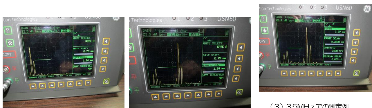
図34 ポータブル探傷計による測定例
