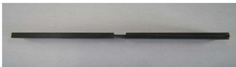
図4.4 高温圧縮試験：許容されない破壊モード
