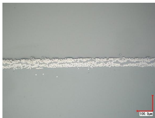
図9 薄層プリプレグシートの断面写真
