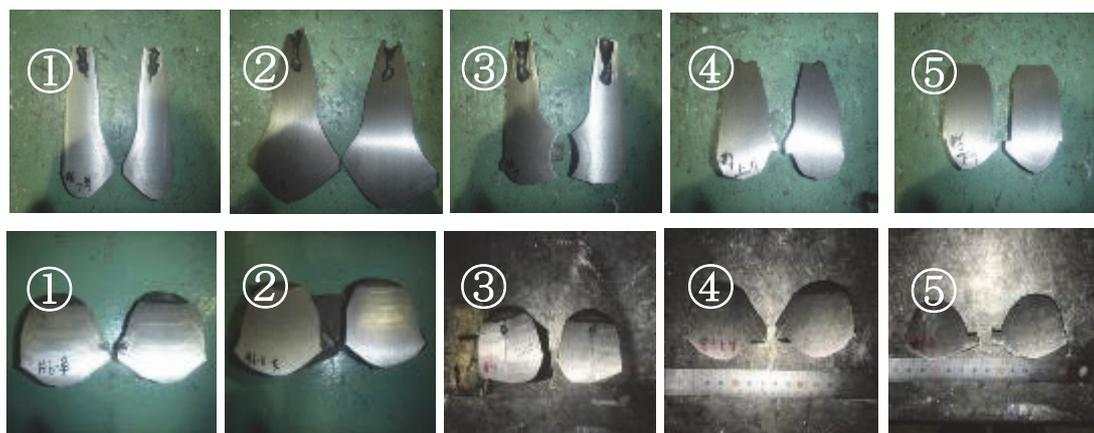
図 2.1.15 押湯の断面状況(上:円柱押湯、下:球状押湯)
