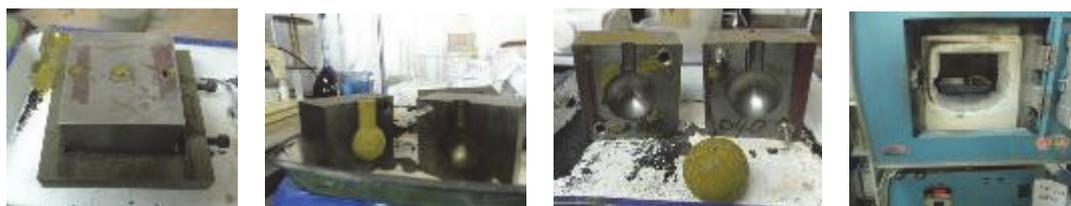
金型 → 成型 → 抜型 → 焼成
