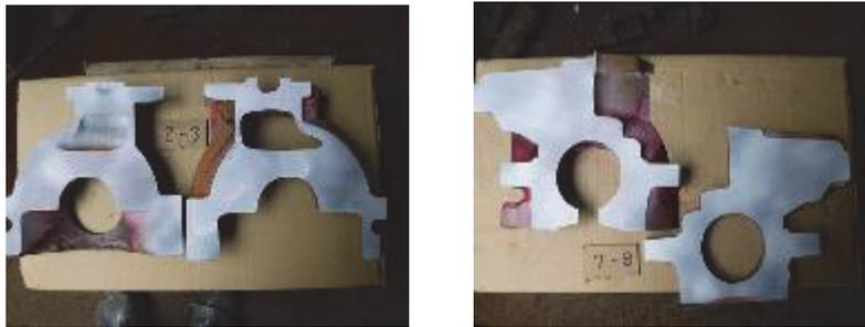
図 2.1.10 ハウジング②の湯口押湯方案の製品切断調査結果
