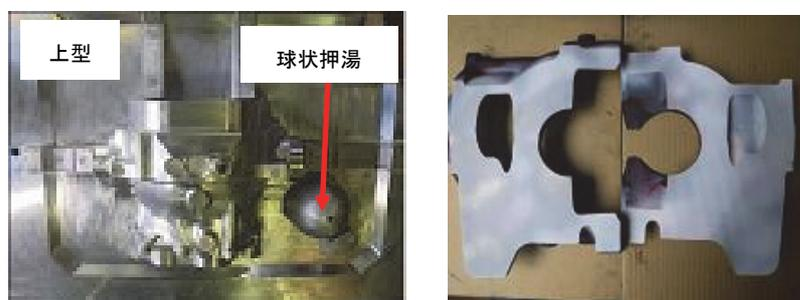
図 2.1.21 ハウジング②の球状押湯方案模型(左)と鋳造品の断面状況(右)
