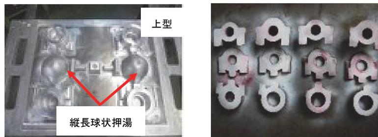
図 2.1.19 シリンダ②の球状押湯方案模型(左)と鑄造品の断面状況(右)
