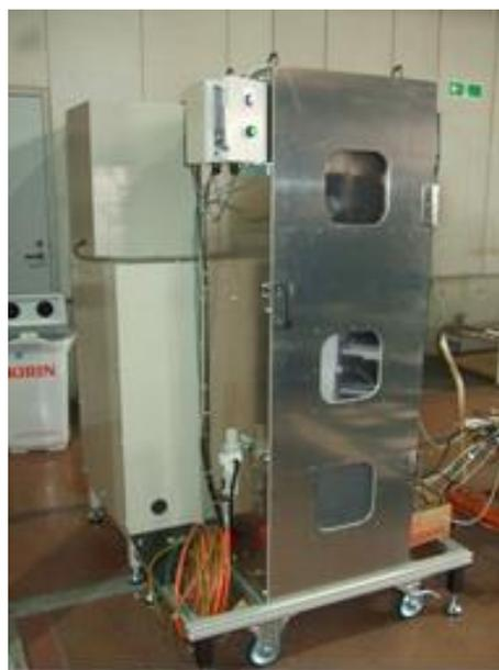
試作衝撃波発生装置、試作ノズル及び試作フィルター等を取り付け、発生する圧力を PCB センサーでとらえて、圧力値、到達速度などを計測する装置
