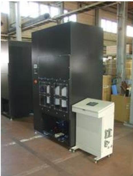
試作衝撃波発生装置、フィルターなどを取り付け、ファイバーレーザー加工機などに取り付けて実際に近い環境でのデータ収集を目的とする装置
