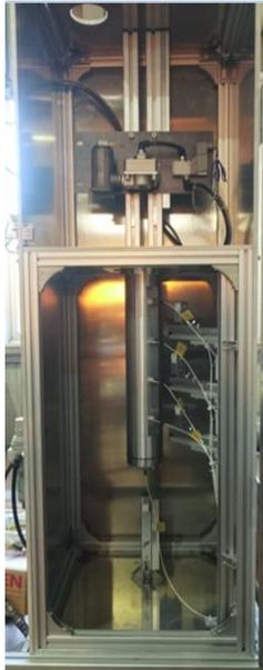
単体試験機圧力試験管及びセンサー部
