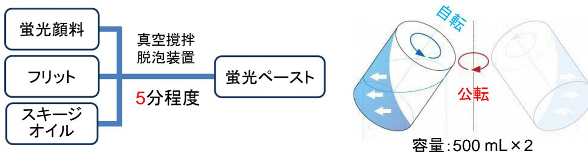
図 2-14 遊星攪拌脱泡機を用いた調製工程と攪拌機構について
