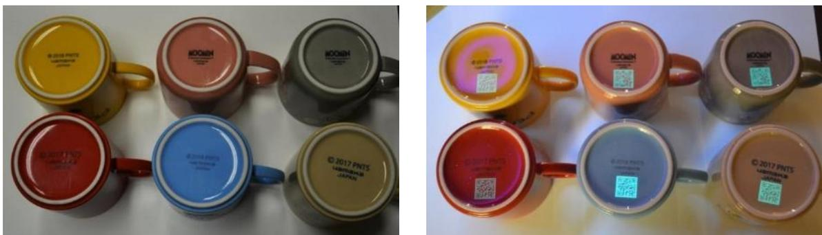
図 2-33 色釉の製品で試作した結果(左:明所、右:ブラックライト照射時)
