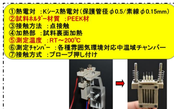
(資料)計測用センサー2 押し付け力と測定精度検証用
