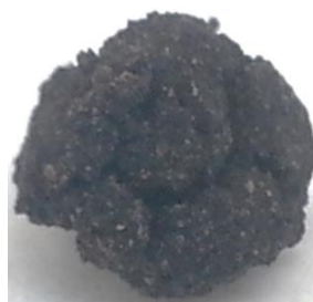
図5 乾燥時の汚泥粒子のひび割れ
