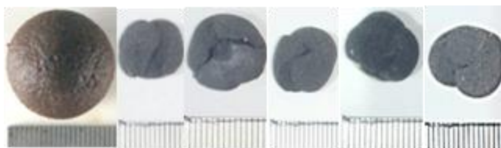
図 1 2 乾燥前後の汚泥試料
