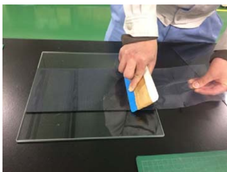
(a)手動施工
