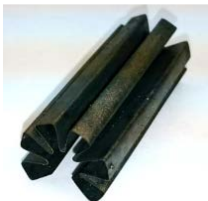
図 2-1 開発した Ni/Al 2 O 3 系プレート形触媒
