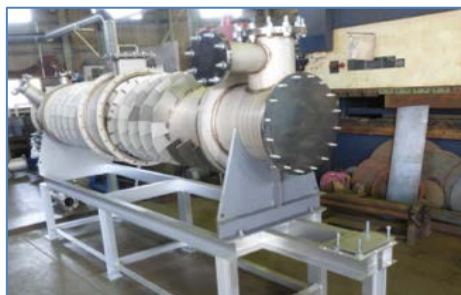
写真 2-1 パドル式ガス化炉
