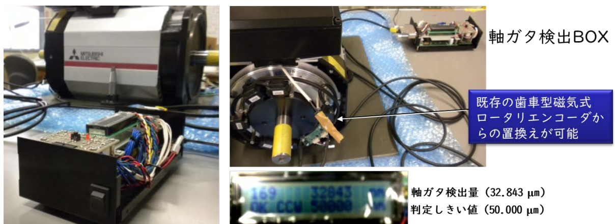
図2-7 開発した歯車型磁気式ロータリエンコーダを 川下製造業者の産業用モータに取り付けて軸ガタ検出実証実験をしている様子
