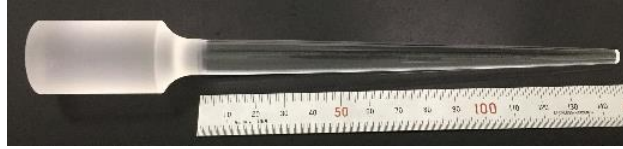
図7 製作した 120mm マンドレル
