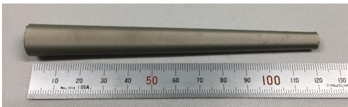
図9 製作した 120mm 長回転楕円ミラー
