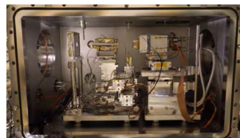
回転楕円ミラーによる軟X線集光の様子
