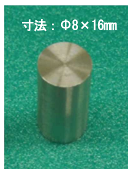
図 2-3 圧縮試験片形状
