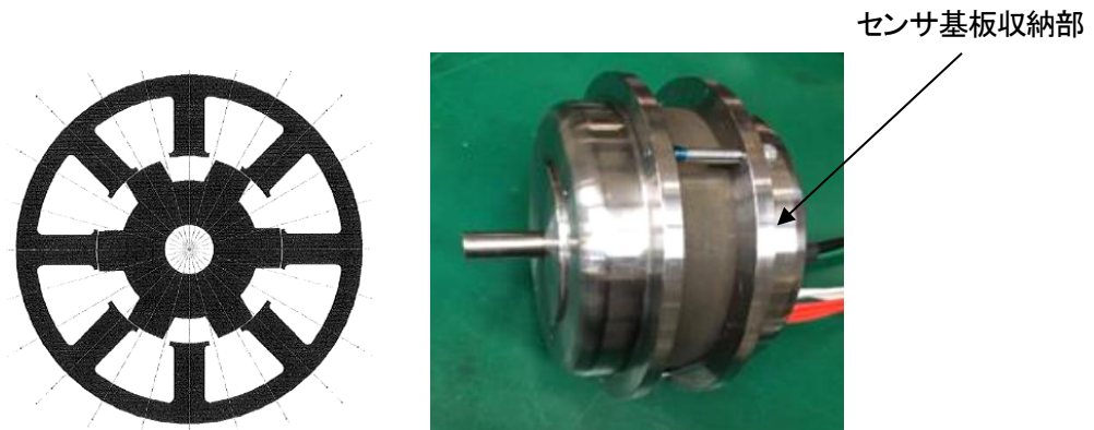
図 2-2-1 4相 SR モータの構造(左)と写真(右)
