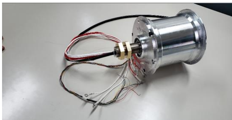
図 2-7-3 SRモータ、遊星ギヤ収納後のドライブユニットケース
