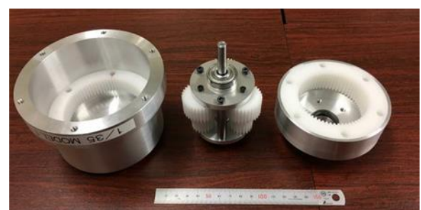
図 2-3-2 試作した軽量遊星ギヤの内部構造(左:1/61、右:1/35)
