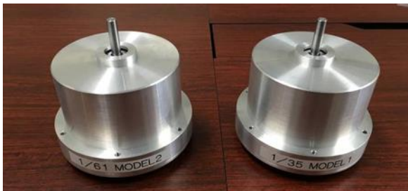
図 2-3-1 試作した軽量遊星ギヤの外観(各写真 左:1/61、右:1/35)
