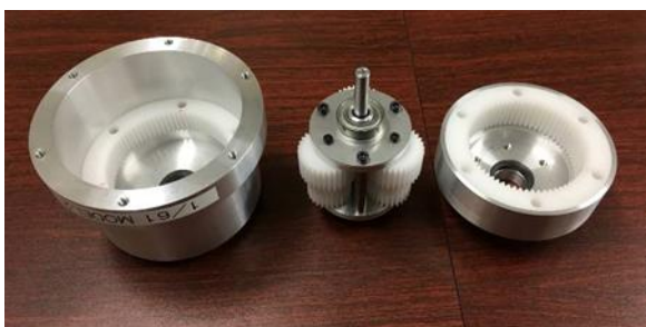
図 2-3-2 試作した軽量遊星ギヤの内部構造(左:1/61、右:1/35)
