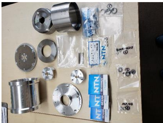
図 2-7-2 収納ケース(ドライブユニットケース)の構成部品
