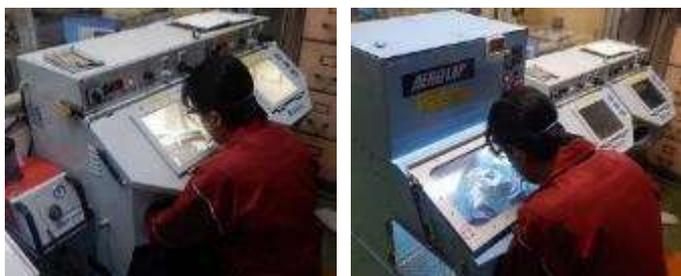
図 2-35 ショットブラストによる磨き工程
