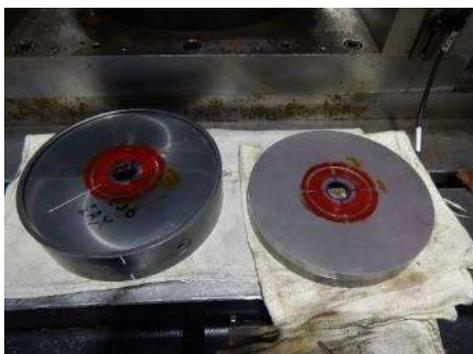
図 2-58 前方押出用ダイインサート
