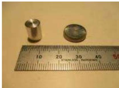
図 2-24 圧縮試験片 試験前後
