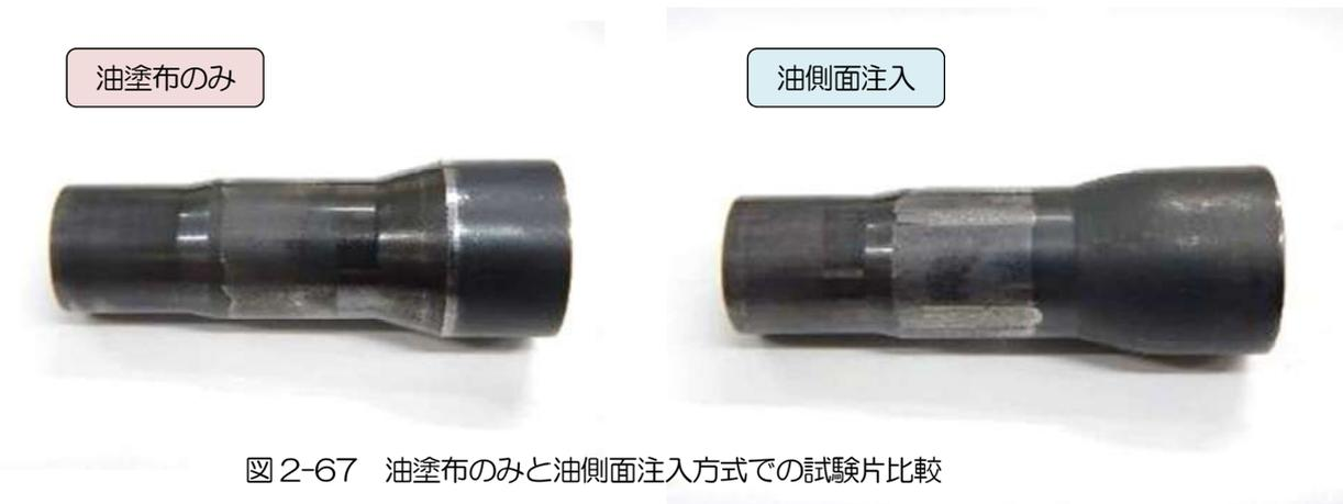
図 2-67 油塗布のみと油側面注入方式での試験片比較
