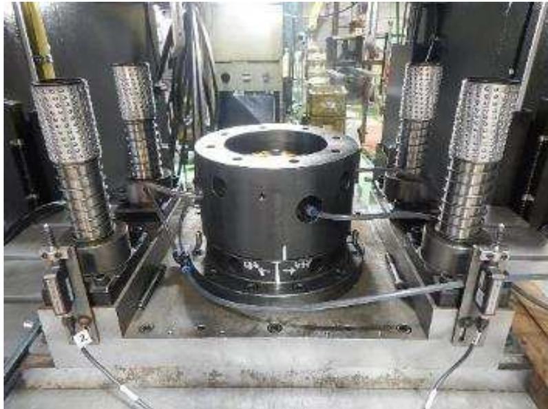
図 2-65 新たな潤滑方式を採用した実験用金型
