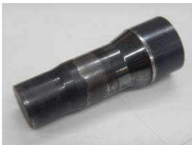
図 2-63 前方押出鍛造（2段）実機テストの結果
