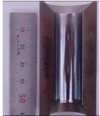
図2-44 R=3%の試験片内面
