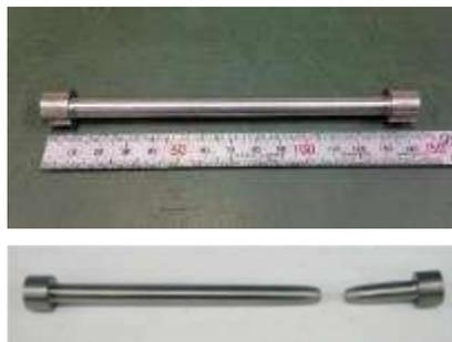
図 2-19 引張試験片 (φ8mm)
