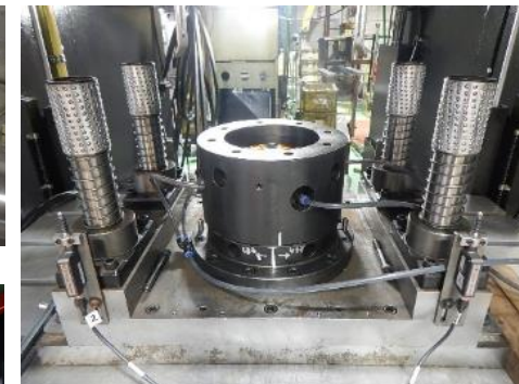
鍛造実験用金型
