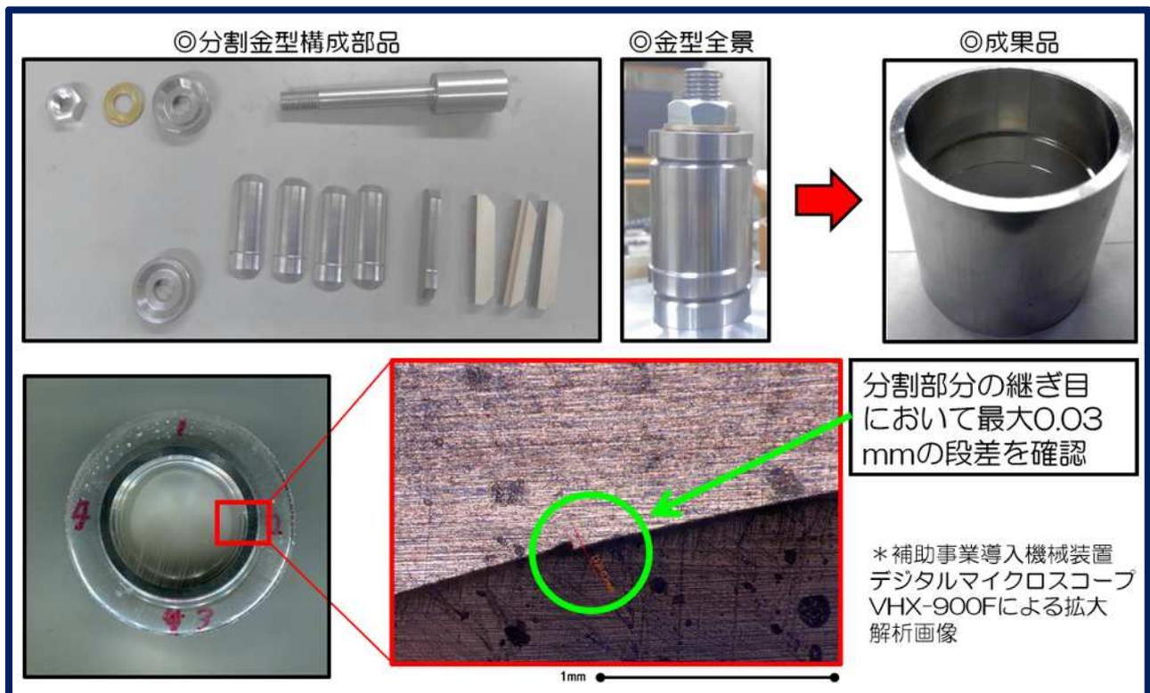
図 17：簡易型による実証試験
