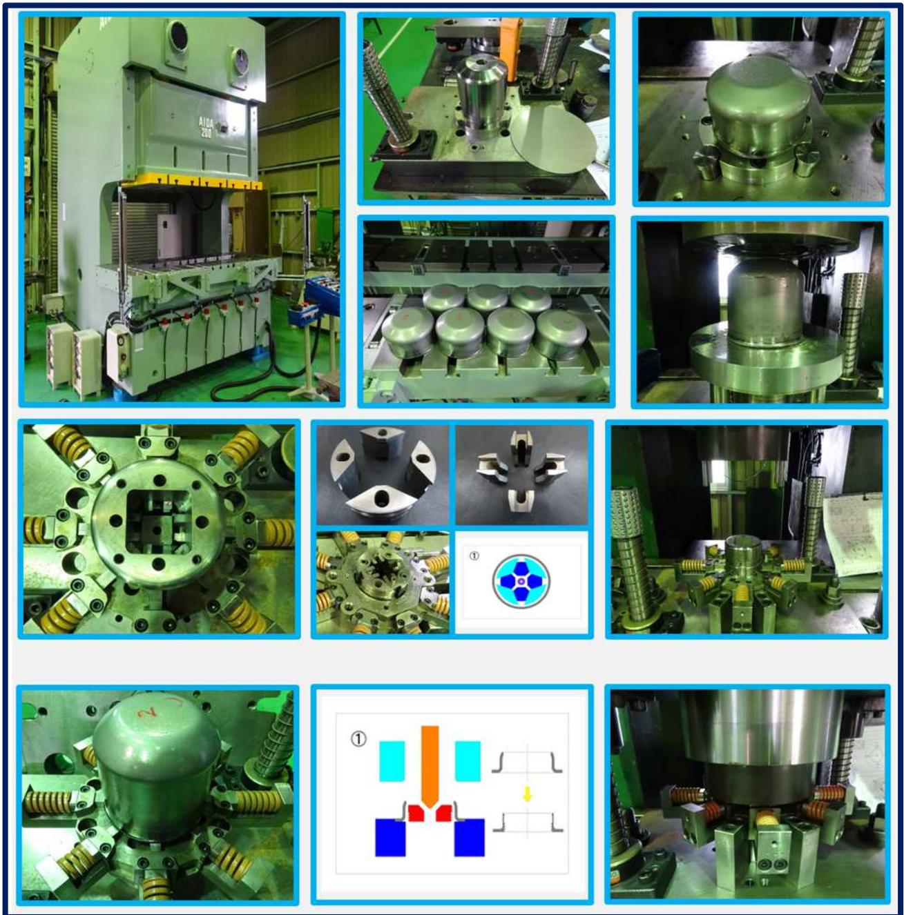
【図 8】 複動カム型を中心とした実証テスト写真
