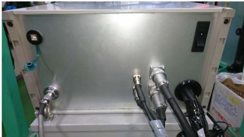
「制御ボックス」 背面の電源配線のコネクタ接続部
