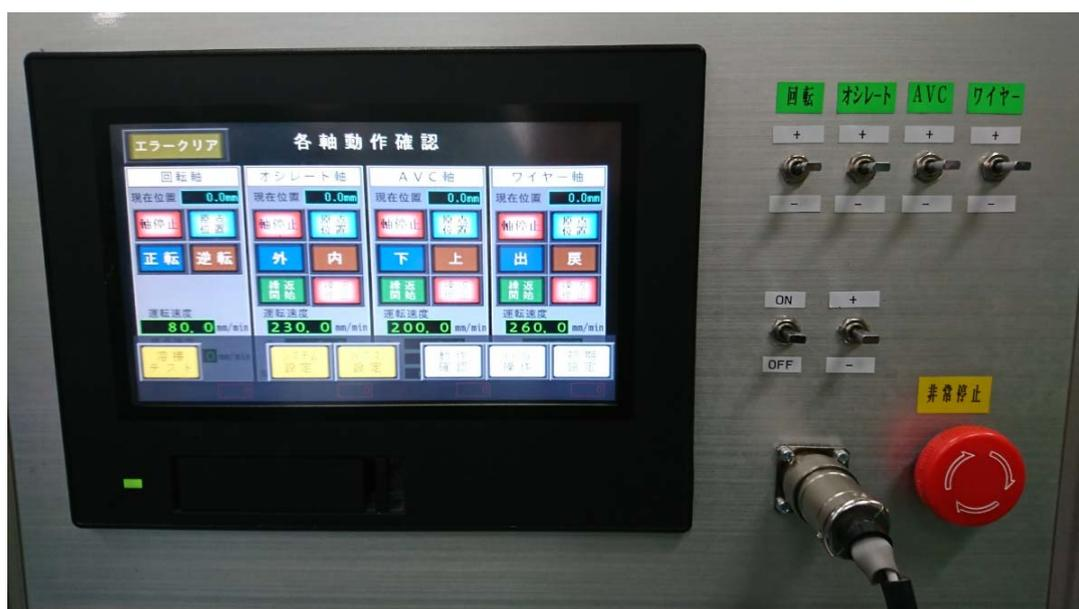
「制御ボックス」(回転ケーブルレス型円周自動溶接装置を自動制御するもの)
