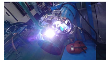
完成した、世界初の「回転ケーブルレス型円周自動溶接装置」
