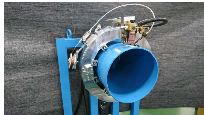
完成した、世界初の「回転ケーブルレス型円周自動溶接装置」
