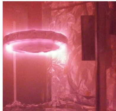
図 2-1-4 安定したプラズマ生成時の写真
