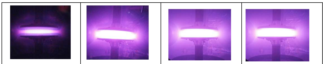
図 2-1-5 電圧変化に伴う電極内パルス放電の変化
