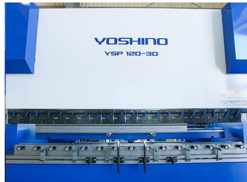
図7 副機 YSP120-30, 加圧力 200t, ワーク 3.0m
