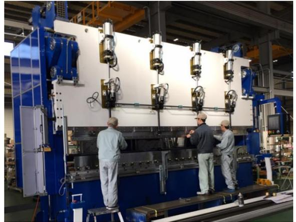
図1 受注した超大型プレス機 320トン 5m
