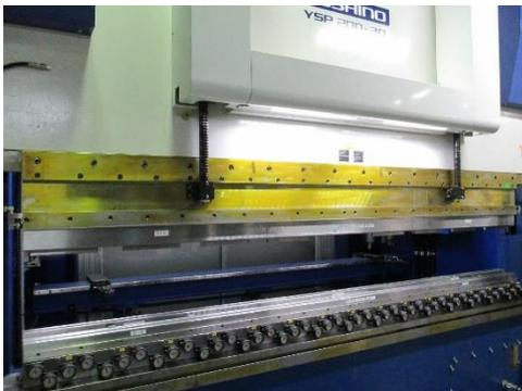
図6 主機 YSP200-30, 加圧力 200t, ワーク 3.0m
